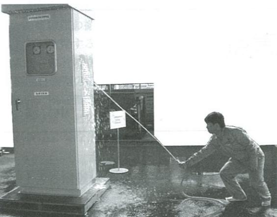
写真-4.2.6 屋外盤・防噴流試験
